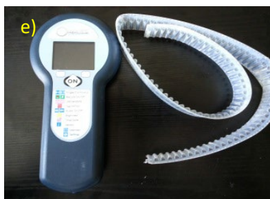
(a) Pit-tag de 32 mm, (b) Perçages carottés des matériaux à la colonne, (c-d) Insertions par collage des pit-tags dans les matériaux percés, numérotés et mesurés, (e) Lecteur pour l'insertion des pit-tags, (f) Prospection des matériaux à pied en rivière à l'aide d'une antenne circulaire (Source : HYDROGEOSPHERE)
