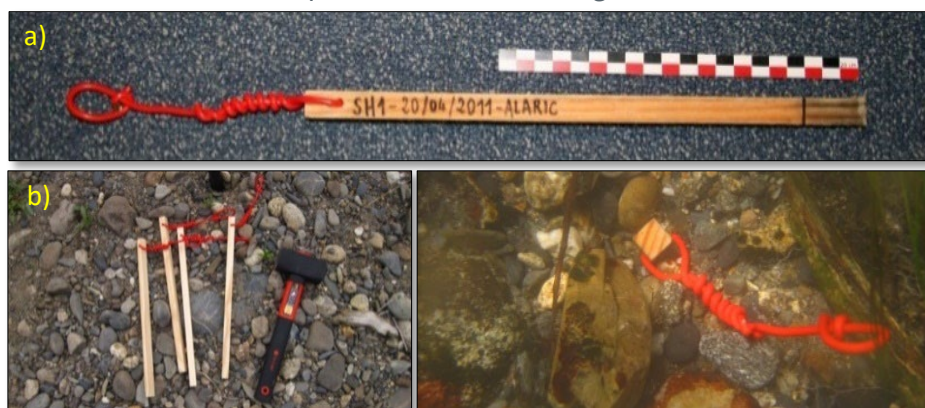
(a) Stick hypoxique après incubation, la partie grisée montre la zone en hypoxie qui n'est pas favorable à la vie aquatique. Entre le trait et le sommet du stick, on a donc l'épaisseur hyporhéique du lit ; (b) sticks hypoxiques avant leur pose en lit ; (c) stick hypoxique mis en incubation
