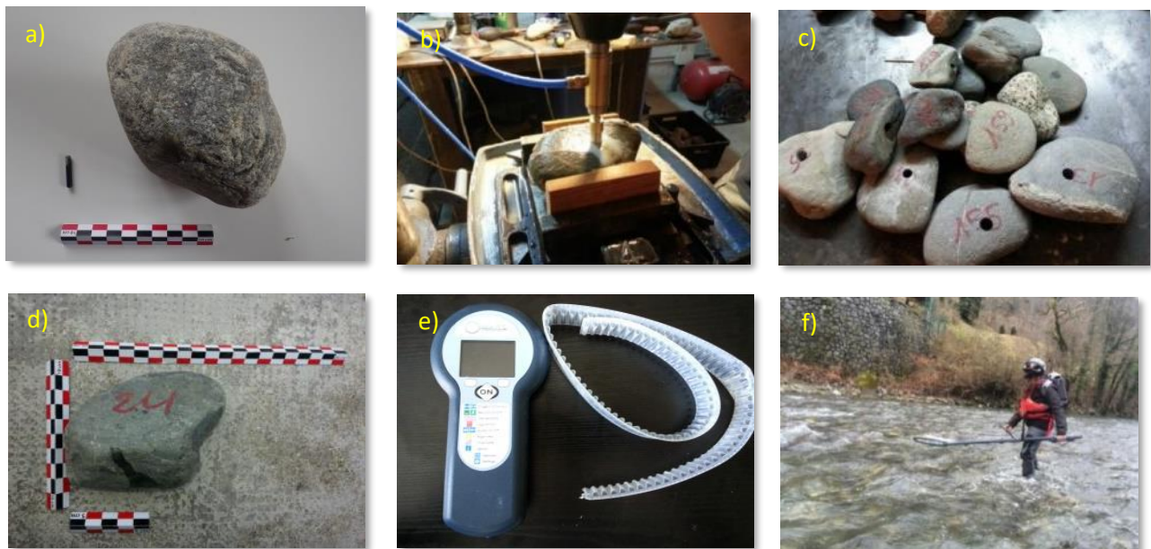
(a) Pit-tag de 32 mm, (b) Perçages carottés des matériaux à la colonne, (c-d) Insertions par collage des pit-tags dans les matériaux percés, numérotés et mesurés, (e) Lecteur pour l'insertion des pit-tags, (f) Prospection des matériaux à pied en rivière à l'aide d'une antenne circulaire (Source : HYDROGEOSPHERE)
