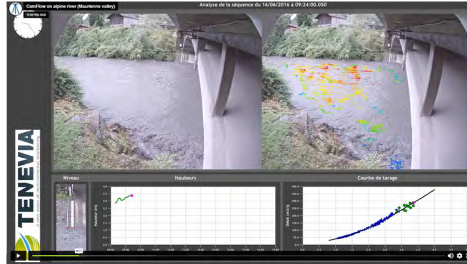
Fig.1 : Exemple de fonctionnement de la caméra Camflow de Tenevia (source : TENEVIA)
