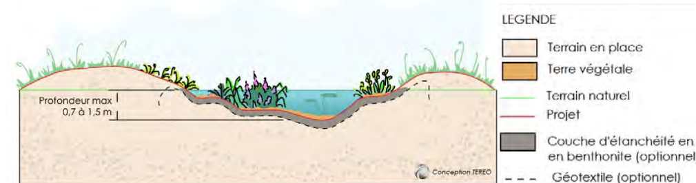
Fig. 5 : coupe de principe de la création d'une mare
