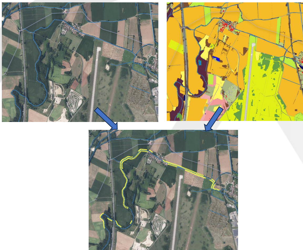
Figure 5 : Illustration du processus de construction des bandes tampons à partir de l'occupation du sol sur le Seymard (en orange, l'occupation du sol correspond aux cultures intensives). Les bandes jaunes sur l'illustration du bas correspondent au périmètre ressource retenus sur le secteur.
