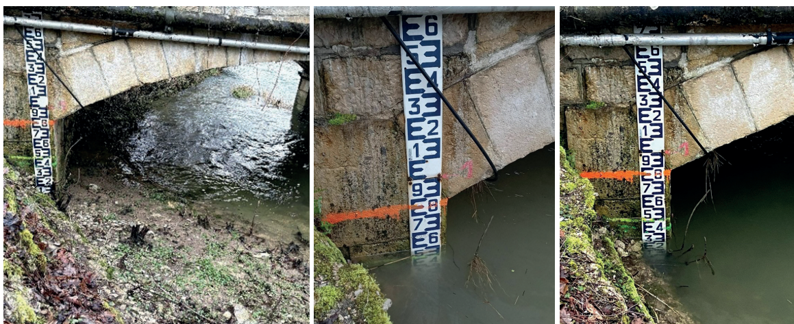
Suivi des niveaux sur un évènement de crue sur échelle limnimétrique du SE des Léchères. 19 fév. à 8h30, 20 fév. à 10h15 et 18h.
